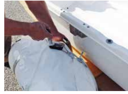
(上)ドーリーのソケットはフェンダーフロートとの共用となっている。こちらは2アクションのストッパー仕様で、海上で簡単に抜けないようになっている
