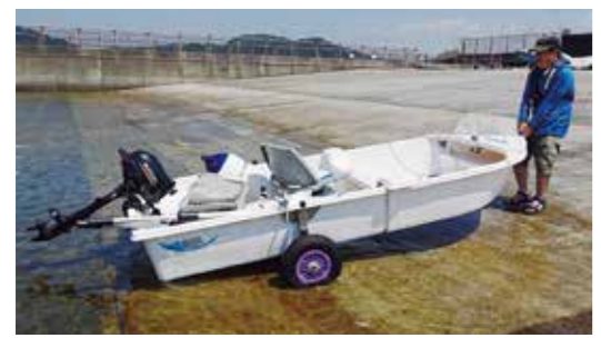
出艇時、スロープからアプローチし船体が浮いたらドーリーを押し下げて外し、フェンダーフロートをセットする。アクシデント対策にドーリーをロープでつないでおくとよいそうだ
