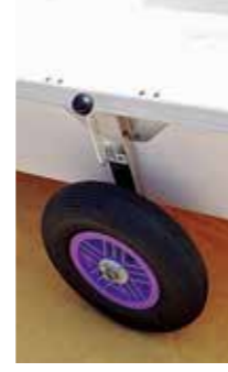
(上)ドーリーのソケットはフェンダーフロートとの共用となっている。こちらは2アクションのストッパー仕様で、海上で簡単に抜けないようになっている
