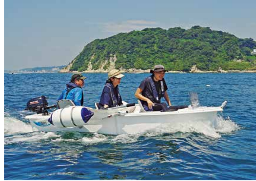
3人乗船しての走り。航走時はサイドのフロートは跳ね上げるので、水が当たり抵抗となることはない。2馬力とは思えないほどのスムーズな走りを見せる
