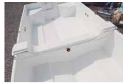
パウ側のバルクヘッド中央に見えるストッパーは、ジョイント板が外れるのを防ぐためのもので、ジョイント自体はフック型の接合部全体がかみ合って大きな強度を担保する
