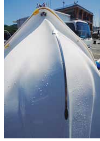
パウのステム部分にはステンレス製のガードが取り付けられている。スターンのキール部分と両サイドにも同様のガードがあり、海底や陸上での摩擦から船体を保護している
