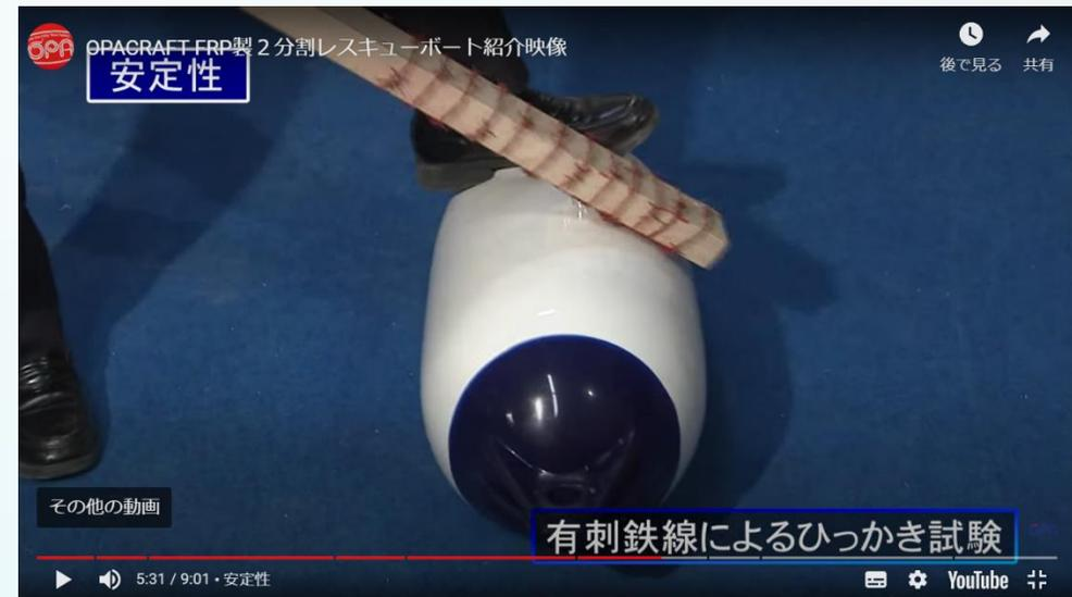
フロート本体には、米国ポリフォーム社のフェンダーを使用。豪華なヨットやクルーザーを何年にも渡り保護し続けられる世界の一流品を業界で初めて採用！有刺鉄線で数百回のひっかけ試験にも合格。
