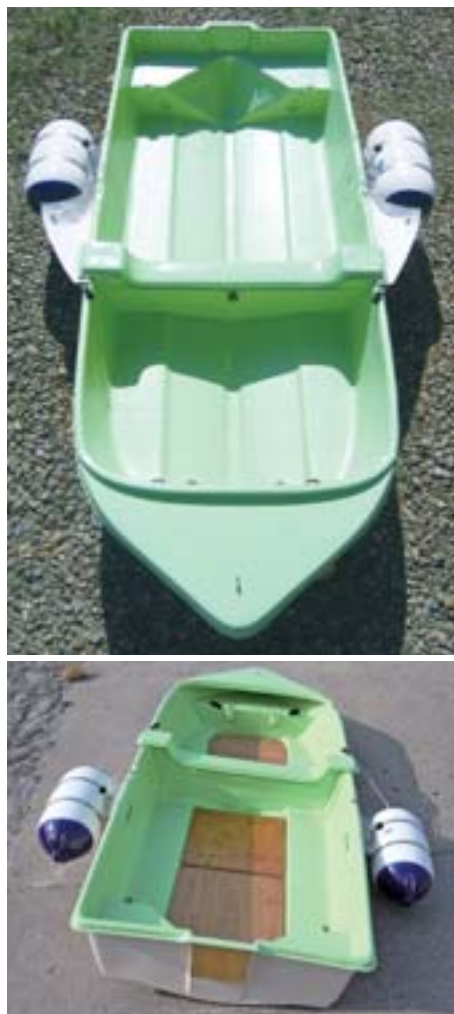
上：両舷に取り付けられたフェンダーフロートAタイプ。フロートは舷側にしっかり固定されており、十分な予備浮力を備えている。キャンバス製のスプレー返しが付いている 下：フェンダー前部の透明な板はスプレー返したが、現在のモデルはキャンバス製のスプレー返しに代わっている
