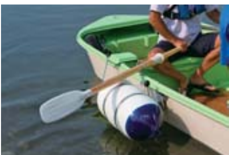
ローイングではフロートがオールと干渉してしまう。オールクランチの位置もしくはフロート取り付け位置を少しずらすことで解決できそう
