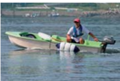
フェンダーフロートを取り付け、2馬力をフルスロットルにした状態。フロートの形状が割とよく、抵抗は少ない。スプレーの上がり方を見るため、スプレー返しは取り外してある
