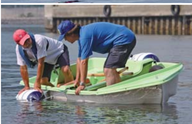
上: 静止状態で体を乗り出したが、これが限界だった 下: 3メートルちょっとのミニポートに2人合わせた体重150キログラムが片舷に重心をかけても、傾斜はこのくらい。フェンダーの浮力は十二分にある
