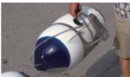
オーバクラフトのフェンダーフロート全景。取り付け用の金具にアイデアと試行錯誤の結果が盛り込まれ、完成度は高い。ハンドルが付いているので、取り付けも楽。運搬にも便利だ
