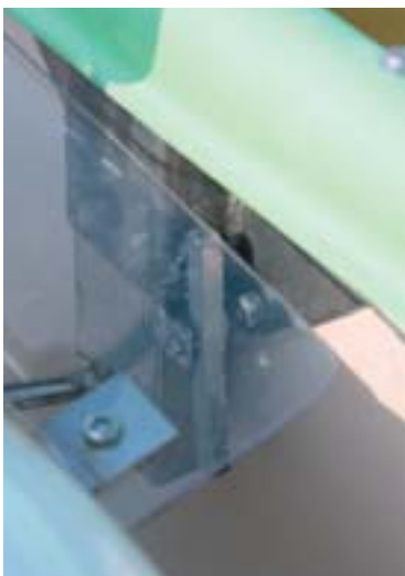
上: がっちりとはめ込まれた舷側のメス金具とフロート側のオス金具 下: メス金具には爪、オス金具にはフックが付く。脱落防止ストッパーになっている
