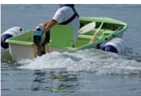
フェンダーフロートにより、旋回時もほとんど船体は傾斜しなかった
