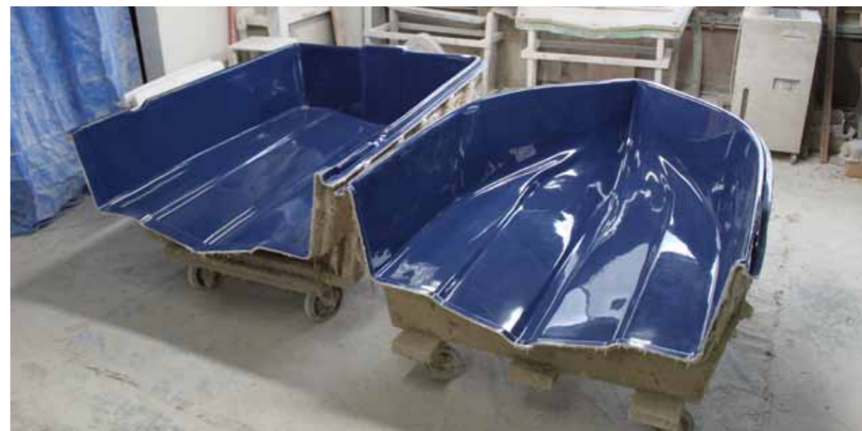
幾度となく改良された分割ボートのモールド
