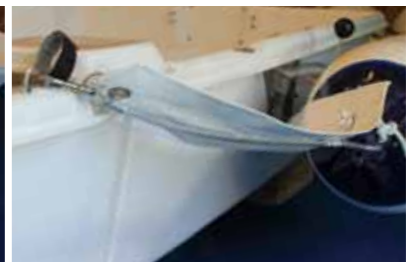
左：釣り人はすぐに海に出たい。装着もワンタッチで、しかも外れないシステムのフェンダーフロート。舷側を守るフェンダー機能だけでなく、横転防止に力を発揮する 右：フェンダーフロートの前方にはスプレーよけが付いており、さらにその下には走航中に浮遊物と接触しても跳ねのけるワイヤが配されている
