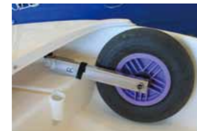
左：左右のサイドに設置するフェンダーフロートを外すと、そこへ簡単に設置できるオリジナルドローリー。写真は外したドローリーを船内に収容したところ 右：船内に収容したドローリーが動かないように、こちらもワンタッチでロックできるシステムになっている
