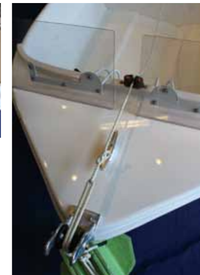
ガラスの200倍の強度があるポリカーボネート製の透明なウェーブブロッカー(波よけ)。左右に動かためアンカーをセットしたときはセンター部分を少し開くことも出来る
