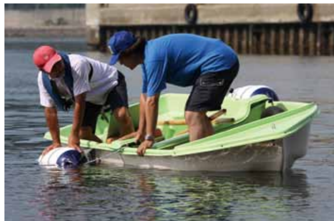
人間が片舷に力を入れても安定しているフェンダーフロート。急な旋回時にも過度な抵抗がなく、小回りがきく操船ができるよう適正な位置に設置されている(写真はフロート用のスプレーよけが未だ設置されていない頃のもの)
