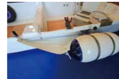
左：釣り人はすぐに海に出たい。装着もワンタッチで、しかも外れないシステムのフェンダーフロート。舷側を守るフェンダー機能だけでなく、横転防止に力を発揮する 右：フェンダーフロートの前方にはスプレーよけが付いており、さらにその下には走航中に浮遊物と接触しても跳ねのけるワイヤが配されている
