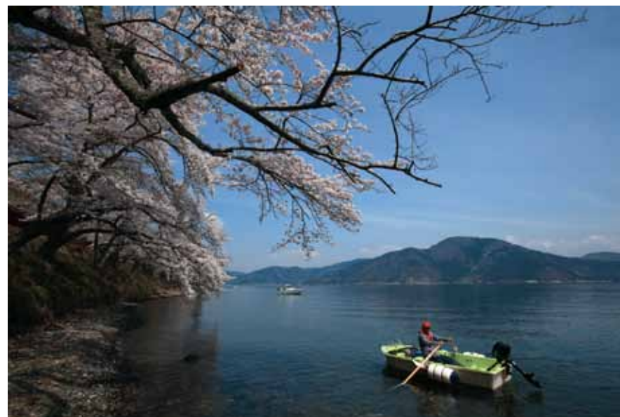
左：水深が浅くなれば船外機をチルトアップし、ローイングでさらに岸边へ近づける。遠方に見えるパワーボートの位置は、岸边に近づく限界だろう 上：浜へ上陸するかなり手前からエンジンをローイングに切り替える
