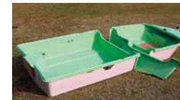
上：オーパボートは分割し、コンパクトにトレーラーへ乗せられる。オール長さもトレーラーの全長にぴったり合ってスマートな収納 下：いざ水面へと漕ぎ出すには、前後の船体を中央にあるバルクヘッド形の楔を差込みしっかり蹴り込むだけ(オーパ社ではその蹴り込むという組み立て方を売り込んでいる)
