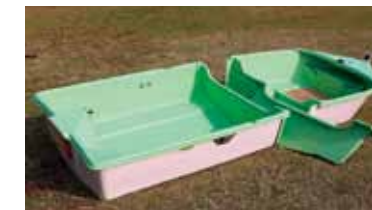
上：オーパボートは分割し、コンパクトにトレーラーへ乗せられる。オール長さもトレーラーの全長にぴったり合ってスマートな収納 下：いざ水面へと漕ぎ出すには、前後の船体を中央にあるバルクヘッド形の楔を差込みしっかり蹴り込むだけ(オーパ社ではその蹴り込むという組み立て方を売り込んでいる)
