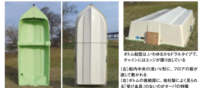
ボトム船型はいわゆるカセドラルタイプで、チェーンにはエッジが張り出している
