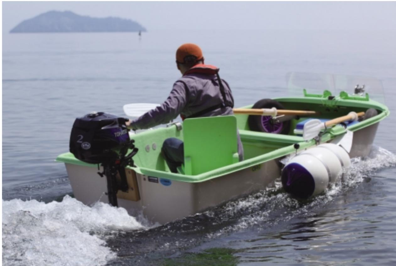
背もたれが量める操縦用の椅子は、フロアに置いてあるだけだが、クッションを乗せるとさらに座り心地もよく安定。右舷のフロートが少し水面についているが、引き波を見ても大きな抵抗感はない
